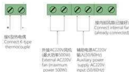
ICM-9KW背板接线端子 ICM-9KW back terminal block
