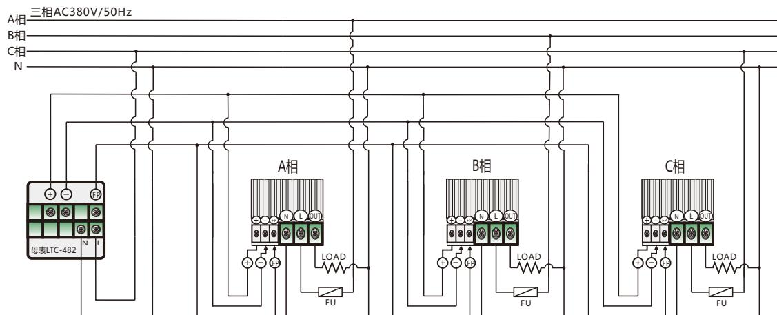
**十、外部电源手动联机+温控仪控制DVC-42接线图**
